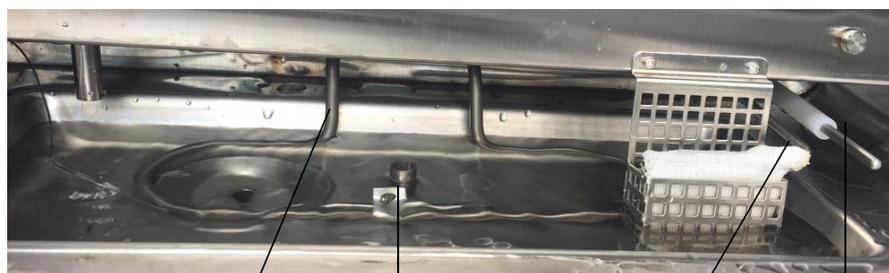
加湿管 温度保护器 (直型)温度传感器
