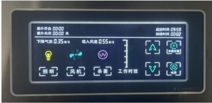
配置了全新的LED液晶面板；可显示仪器启动时间及仪器运行时间；同时能显示下降气流及吸入风速；并配有高效过滤器更换提醒功能及紫外灯预约定时开启和定时关闭功能。
