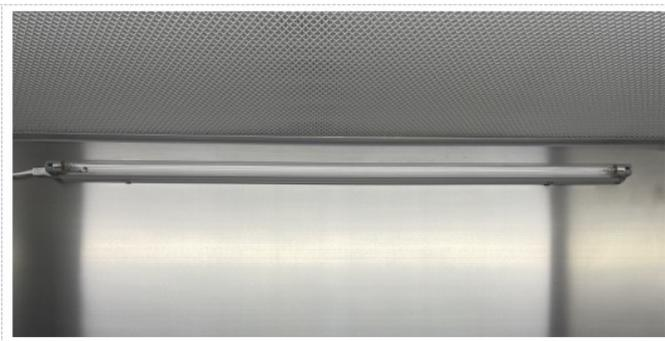
操作区域内配置了一体式的LED灯架及紫外线灯架，方便实验人员后期插拔更换。
